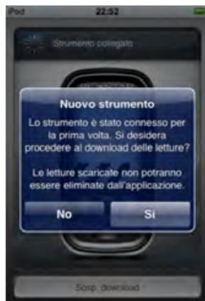
**[6] Sincronizzare i risultati:** dopo la prima sincronizzazione tra lo strumento BGStar® e l'applicazione, la sincronizzazione avverrà automaticamente ogni volta che lo strumento viene collegato al proprio iPhone o iPod touch attraverso il cavo e con l'applicazione in esecuzione. Se non si desidera che venga eseguita la sincronizzazione tra lo strumento BGStar® e l'applicazione, toccare il pulsante "SOSP. DOWNLOAD".
